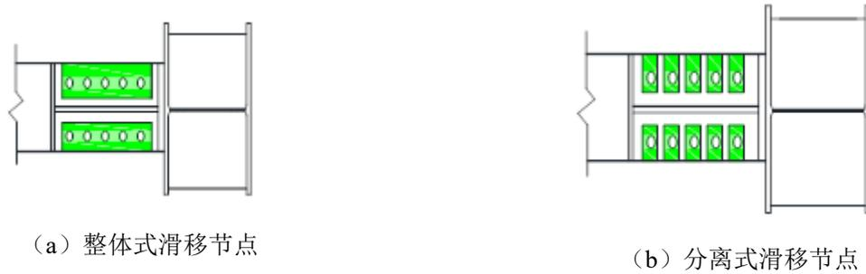
图1 滑移垫板构造形式示意图
